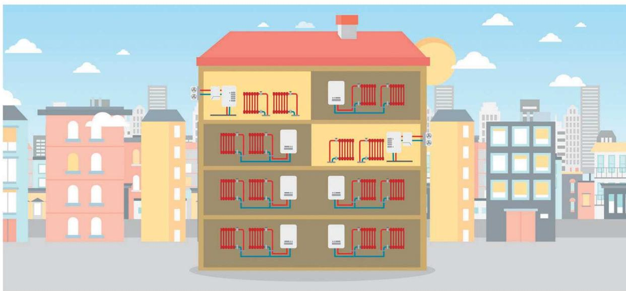
La aerotermia es un sistema de climatización que aprovecha la temperatura del aire ambiente exterior para disminuir el salto térmico que tiene que conseguir una bomba de calor a partir del agua que coge de la red de distribución.
